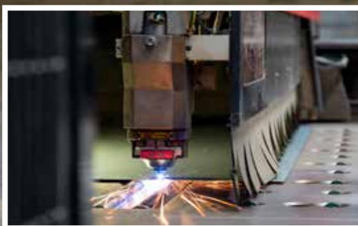
De lasersnijmachine zorgt voor precisiewerk tot een honderste millimeter nauwkeurig.
